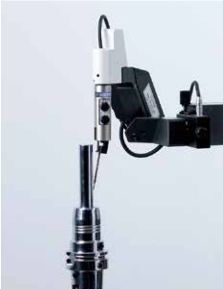
オフセット型 CNC 検出器ホルダ (オプション) を利用した真円度測定例
